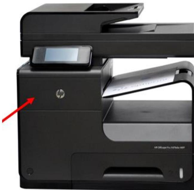
Inkjet uložak iz uređaja otkopčate pritiskom na uložak prema uređaju. Nakon što uređaj izbací prazan uložak, možete ga bez primjene sile izvući. Potom na isto mjesto umetnete pun uložak. Pazite da prazan uložak zamijenite punim za istu tintu (npr. prazan uložak M zamijenite punim uloškom M) te da je inkjet uložak pravilno okrenut. Nakon što je uložak umetnut, zatvorite prednja vrata.
