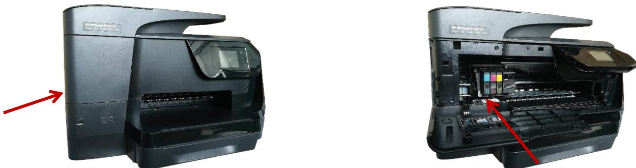
Pričekajte da se glava za ispis pomakne uljevo i zaustavi. Inkjet uložak iz uređaja otkopčate pritiskom na uložak prema uređaju (desna fotografija) Nakon što uređaj izbací prazan uložak, možete ga bez primjene sile izvući iz glave za ispis. Potom na isto mjesto umetnete pun uložak. Pazite da prazan inkjet uložak zamijenite punim za istu tintu (npr. prazan inkjet uložak M zamijenite punim uloškom M) te da je uložak pravilno okrenut. Nakon što je uložak umetnut, zatvorite gornji dio uređaja.
